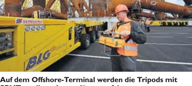
Auf dem Offshore-Terminal werden die Tripods mit SPMTs zu ihren Lagerplätzen gefahren.
