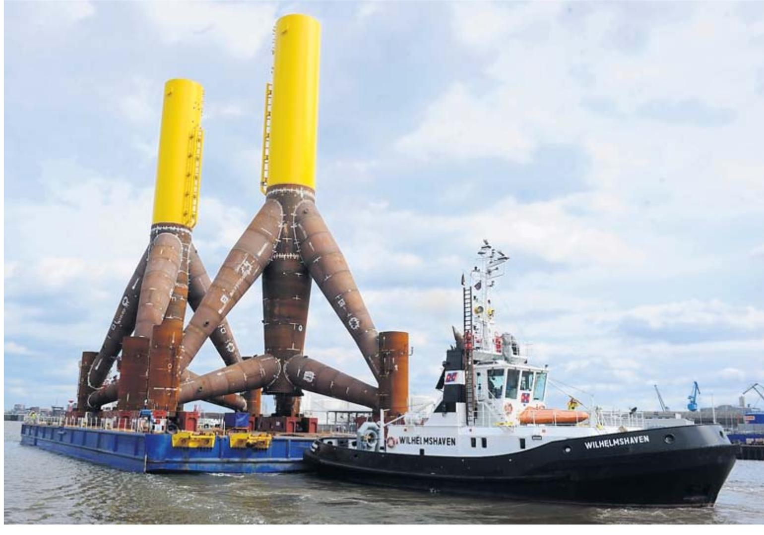
Spezialschiffbau: Der Ponton „OFFSHORE BHV I“ transportiert Gründungsstrukturen für Windparks
